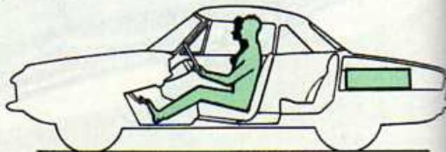
Massime condizioni di peso in esercizio: vettura completamente rifornita, 2 persone a bordo e kg. 20 di bagaglio: kg. 1090 dei quali kg. 590 (53,9 %) all'avantreno e kg. 505 (46,1 %) al retrotreno.
