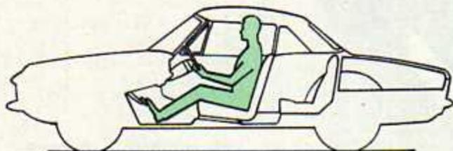
Minime condizioni di peso in esercizio: vettura parzialmente rifornita (metà serbatoio carburante) e solo guidatore: kg. 990 dei quali kg. 560 (56,6 %) all'avantreno e kg. 430 (43,4 %) al retrotreno.
