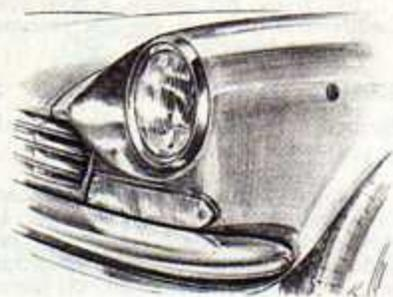
Particolare del faro anteriore arretrato rispetto al profilo della vettura. Sotto è il complesso indicatori direzione e luci posizione.
