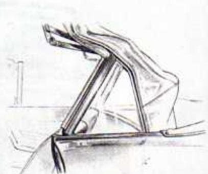
Il finestrino laterale ruota su un perno e scompare in un alloggiamento.
